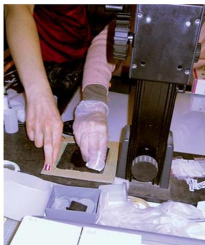
▲ Figure 1. Présentation du montage « pompe + cassette » (a) et du positionnement de l'échantillonneur au niveau des voies respiratoires d'un restaurateur (b).
