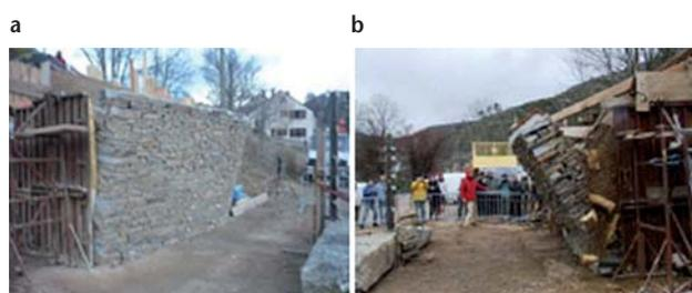
▲ Figure 3. Murs testés par Colas *et al.* [7] : (a) rupture du mur « paysan », (b) rupture du mur « ingénieur ».
