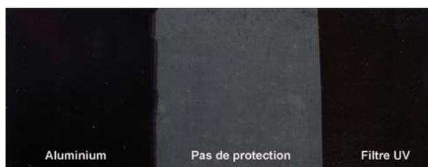
▲ **Figure 5.** Photographie de la surface de laques de référence multicouches appliquées sur support de bois après un vieillissement artificiel de quatre semaines, simulant une exposition de 320 ans à 50 lux (enceinte Servathin, lampe à halogénures métalliques Osram, source Atlas Solar, 1 500 W, 22 °C, 50 % d'humidité relative). © C2RMF, A.-S. Le Hô
