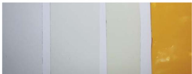
▲ Figure 8. Échantillons d'un support photographique vieilli à l'air ambiant à 110 °C (0, 8, 16 et 32 jours).
