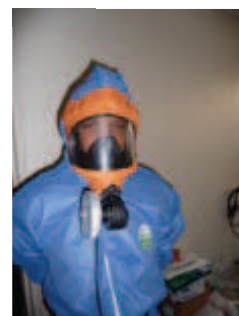
Masque complet à ventilation assistée TM3 P (interventions de plus longue durée et pénibilité réduite)
