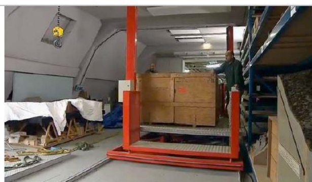
Pont mobile mécanisé permettant le transport des tables des plans reliefs ou caisses sur la longueur d'Asfeld
