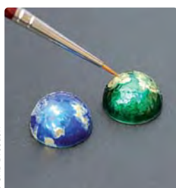
Consolidation d'émail par infiltration avec ORMOCER®.
