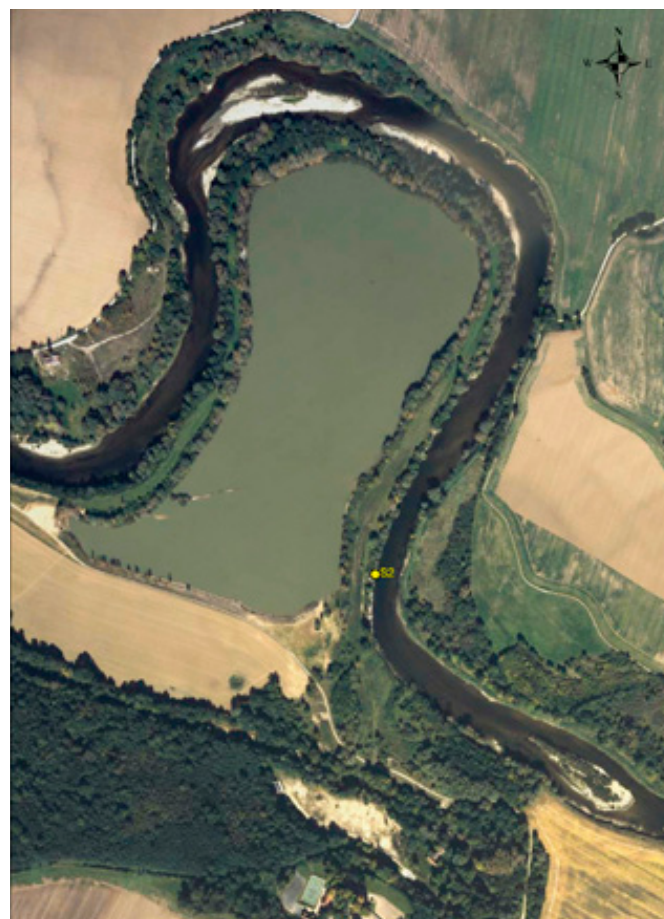
Fig. 50 : Exemple d'un recouplement d'une boucle de méandre dans la vallée du Cher (18). Tiré de la présentation de Thomas Dépret, rapport PCR 2009, p. 69
