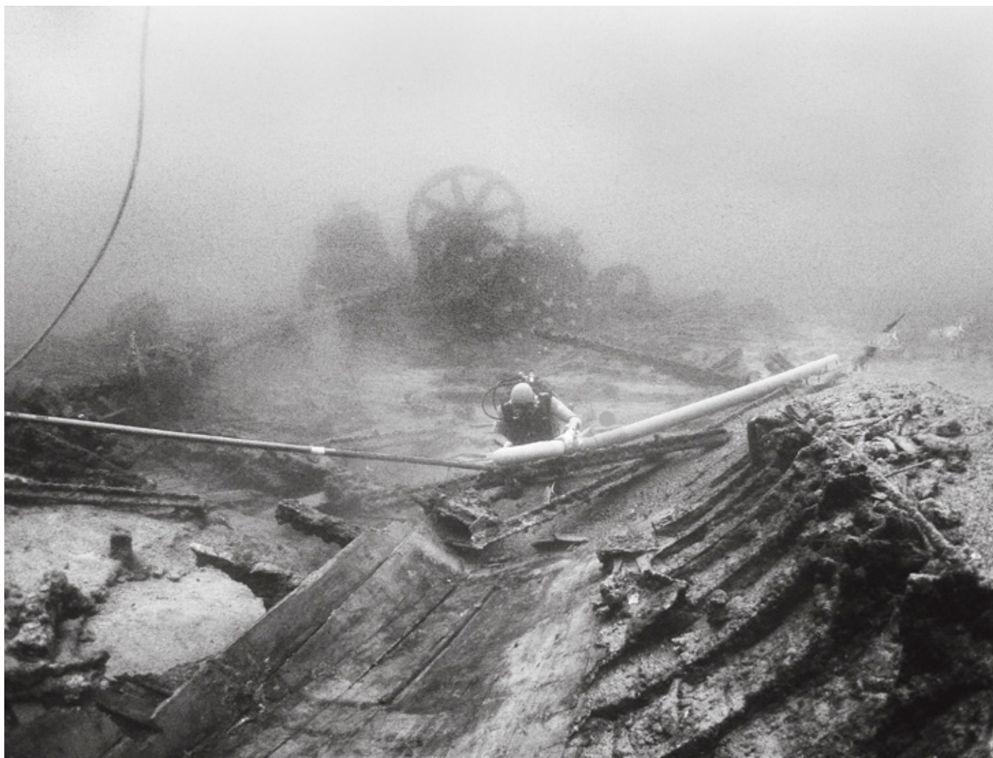
Fig. 35 : Vue générale de la zone dégagée en 2009 : à gauche, l'arbre d'hélice ; devant, les virures du pont inférieur et du vaigrage ; au fond, la machine ; à droite, le flanc tribord du bâtiment
